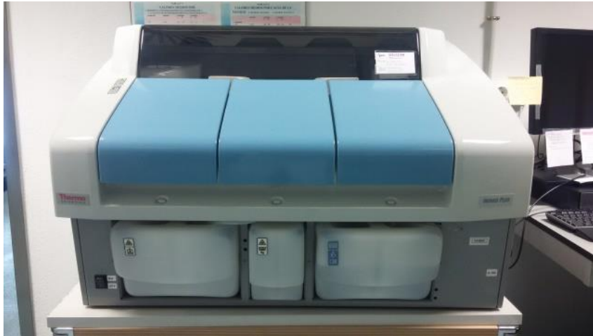
Imatge 19: Autoanalitzador d'immunoassaig Indiko Plus® de ThermoFisher Scientific del SLF
