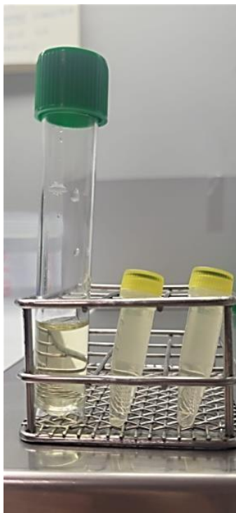
Imatge 6. Exemple de com minimitzar la càmera d'aire amb recipients de menor mida (en el tub i en els dos eppendorfs hi ha la mateixa quantitat d'orina, 3mL)
