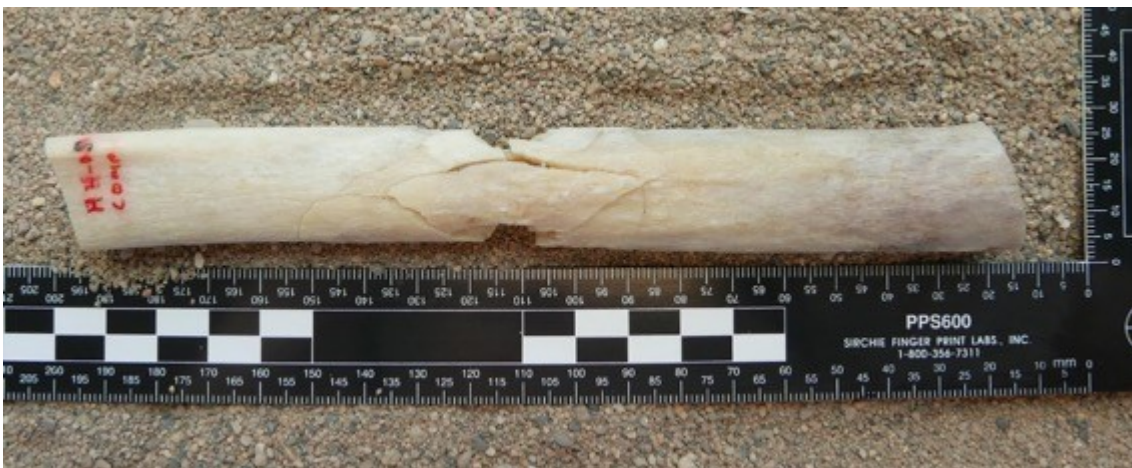
Figura 20. Exemplar d'humer humà que exemplifica la consolidació de la fractura, un cop disparat, esqueletitzat i condicionat el material ossi. La fractura s'ha consolidat amb un pegament comercial d'us domèstic a base de nitrat de cel·lulosa.
