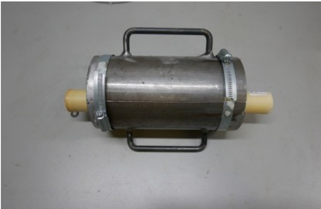
Figura 5. Dispositiu metàl·lic per construir el motlle al voltant de l'espècimen. En la imatge s'il·lustra amb un os sintètic.
