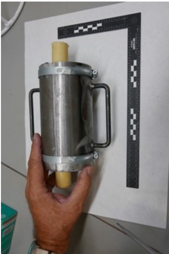
Figura 6. Procediment de rebliment del motlle amb gelatina balística líquida. En la imatge s'il·lustra amb un os sintètic. El motlle es deixa assecat amb un peu metàl·lic que permet garantir la verticalitat.
