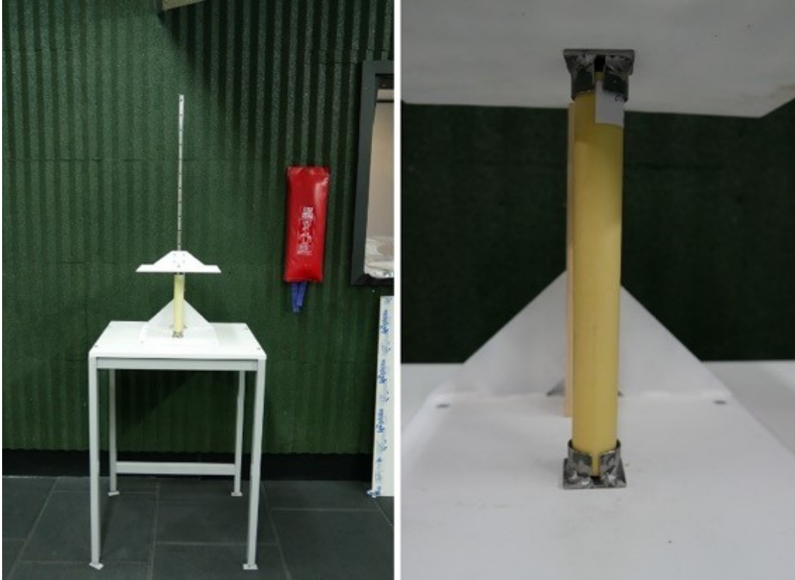
Figura 11. Dispositiu de subjecció axial basculant que permet col·locar l'espècimen a disparar en posició vertical. La plataforma superior és mòbil, el que permet ajustar diferents longituds d'os. Tant la plataforma superior, com la inferior, porten uns sistemes de subjecció que permet aguantar l'espècimen en aquesta posició. Aquests sistemes, son variables en funció de si es tracta d'ossos sintètics, animals o humans. En aquest cas veiem col·locat un os sintètic.
