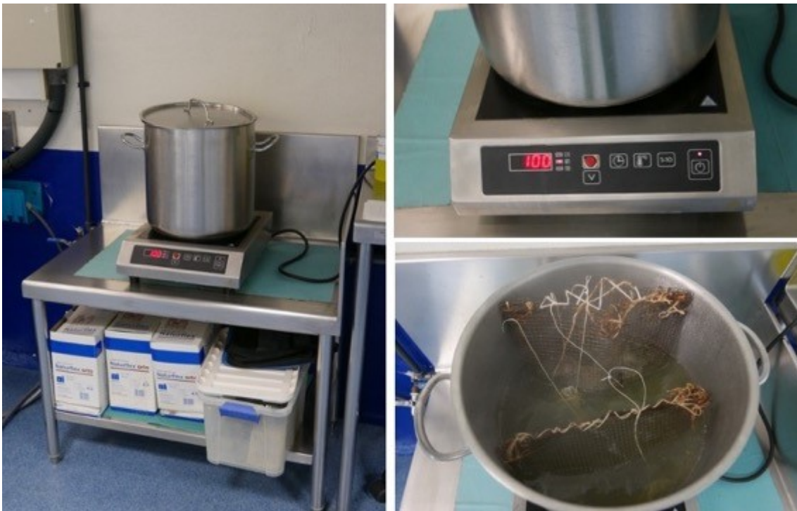
Figura 18. Procediment de maceració amb aigua calenta, per esqueletitzar els espècimens biològics animals i humans. El protocol seguit fou el de Scheirs et al., (2017).
