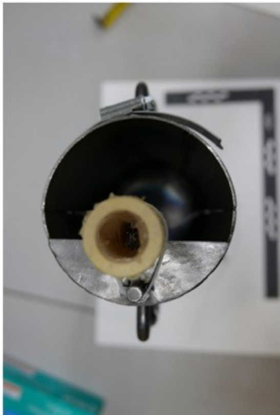
Figura 6. Procediment de rebliment del motlle amb gelatina balística líquida. En la imatge s'il·lustra amb un os sintètic. El motlle es deixa assecat amb un peu metàl·lic que permet garantir la verticalitat.
