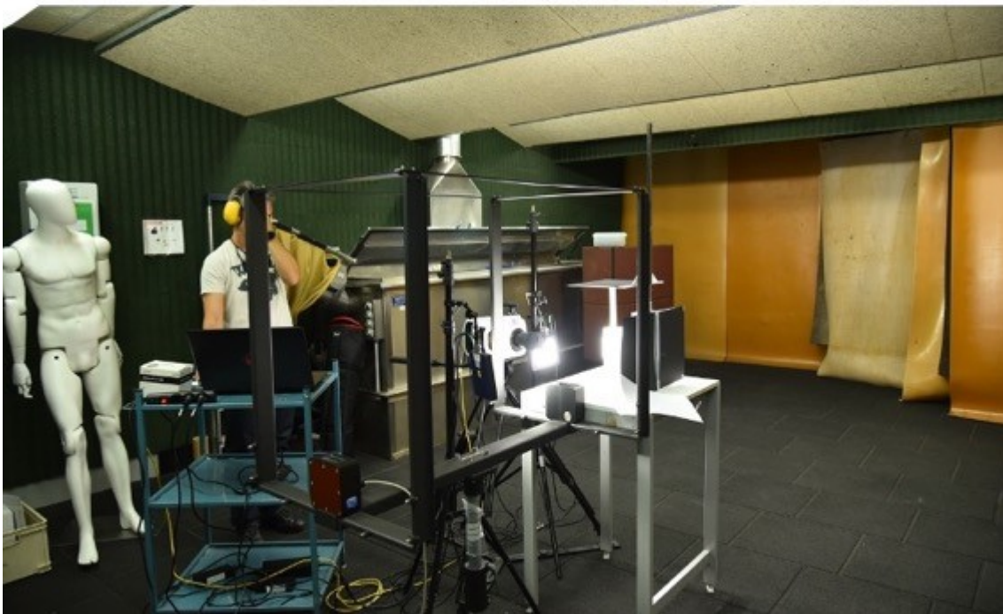
Figura 13. Entorn experimental en el laboratori de balística. Els blocs de gelatina, amb els espècimens a l'interior, s'han col·locat a 2 metres de l'arma de foc, emprant un simulador balístic de tret (Laboratori de Balística de Mossos d'Esquadra). Sensor de moviment Drello LS 11-03 amb un sistema computeritzat associat Drello VC 4043-09 Càmera d'alta velocitat (Phantom V2012) de fins a 663000 fps (fotogrames per segon).
