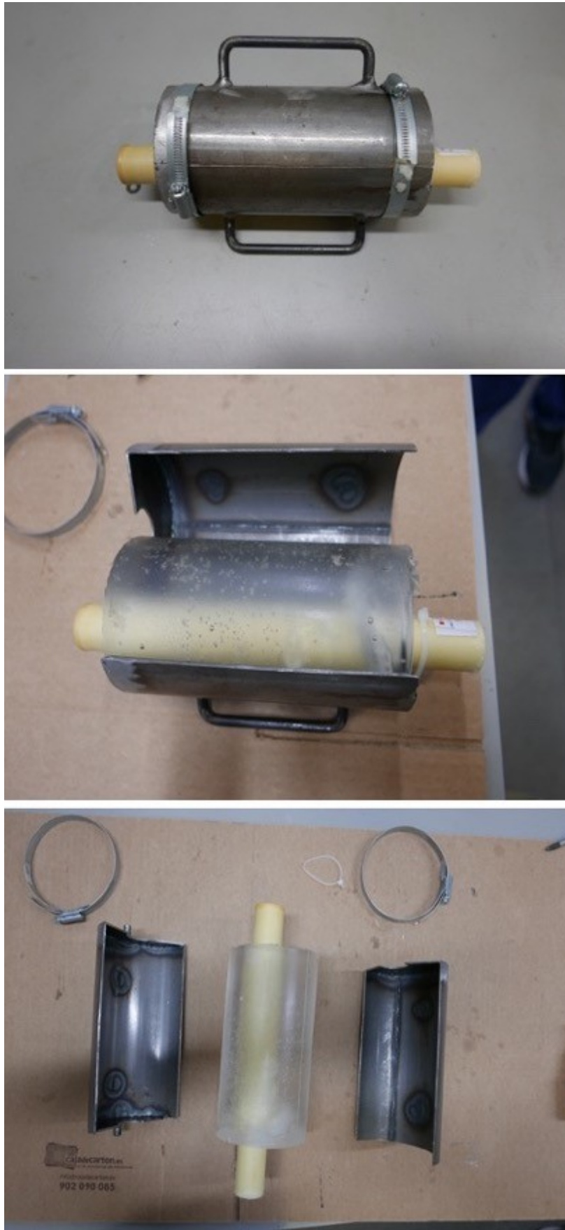
Figura 7. Obertura del dispositiu metàl·lic i extracció del motlle. En la imatge s'il·lustra amb un os sintètic.
