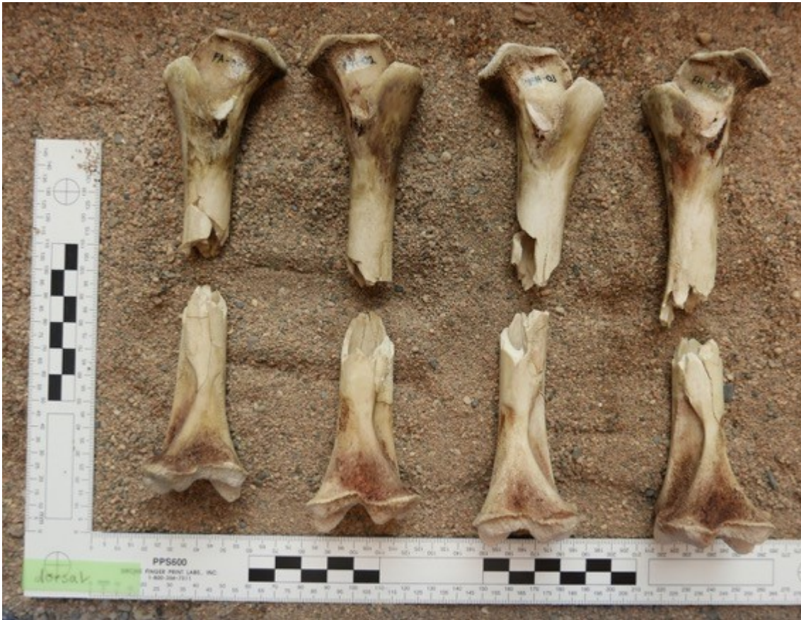
Figura 24. Visió posterior dels espècimens animals un cop disparats a la zona mitja de la diàfisi. El patró mostra una important pèrdua de substància en la zona de sortida, que impossibilita la seva reconstrucció. S'identifiquen fractures radiades o secundàries, que parteixen de l'àrea de sortida.
