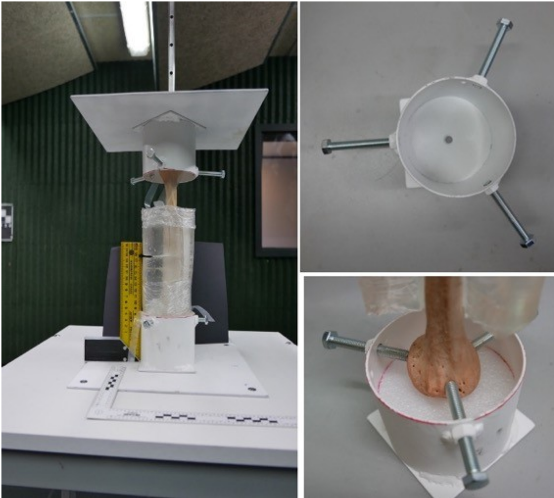
Figura 12. Dispositiu de subjecció axial basculant amb os humà subjectat, rodejat per bloc de gelatina. A la dreta, detalls del sistema de fixació proximal i distal. El sistema evita la lesió de l'os, per tant artefactuar els resultats creant punts de dissipació de l'estrès.
